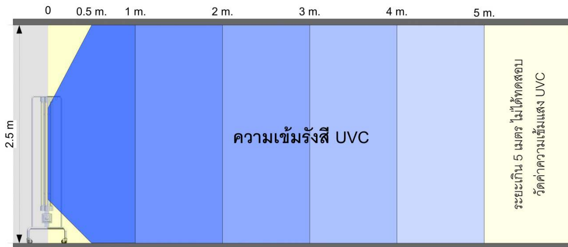
รูป : จำลองภาพตัดการปล่อยรังสี UVC ที่ชี้กหนึ่งของเครื่อง UVC Stand
